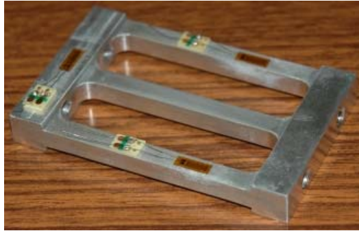
Figure 5 – Jauges de contraintes collées sur la pièce mécanique subissant les efforts
