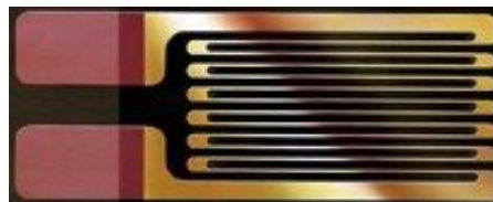
Figure 4 – Schéma d'une jauge de contrainte
