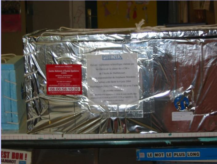
*Elle ne doit pas peser plus de 2,5 kg. Elle est faite en polystyrène extrudé (un matériau léger et résistant).*
