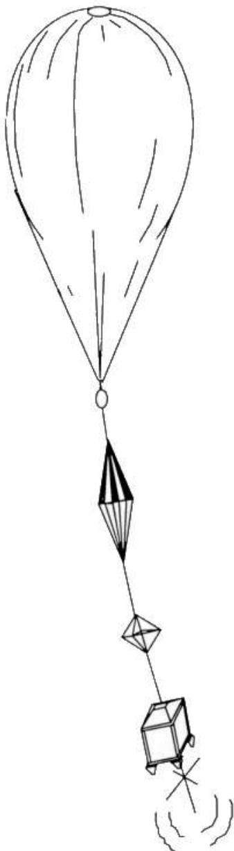
**L'enveloppe** est fabriquée avec un matériau très élastique (latex ou chloroprène) de quelques microns d'épaisseur. Elle est gonflée à l'hélium, gaz inerte moins dense que l'air. Ce gaz rare est ininflammable et donc parfaitement sans danger.
