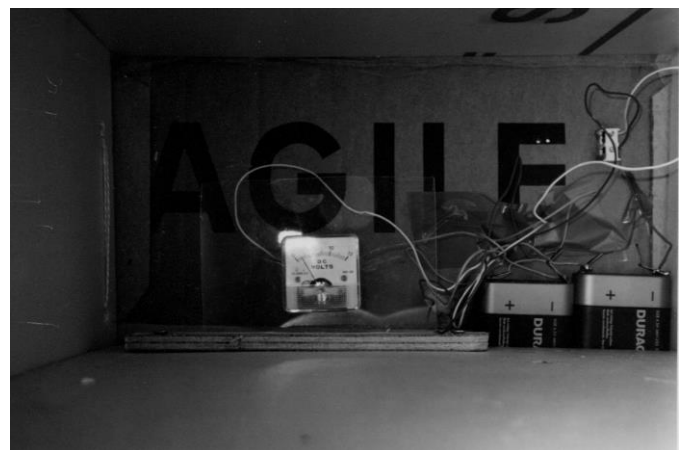
Photographie en vol d'un voltmètre relié à une thermistance placée à l'extérieur
